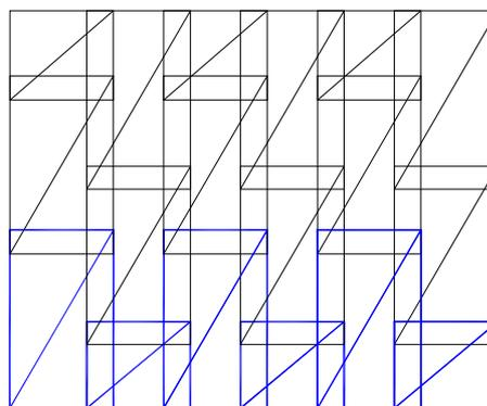
Pose horizontale: 6 plaques avec recouvrement 57.9cm
